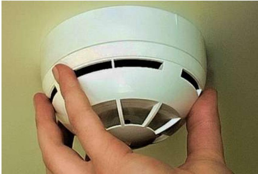
Одним из наиболее эффективных средств по предупреждению гибели людей от пожаров считается автономный пожарный извещатель. Это устройство реагирует на дым еще на стадии возгорания, когда потушить огонь можно подручными средствами, накрыв плотным покрывалом, вылив стакан воды или засыпав землей из цветочного горшка.
